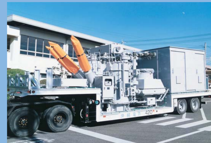
車積載形移動用変電設備
